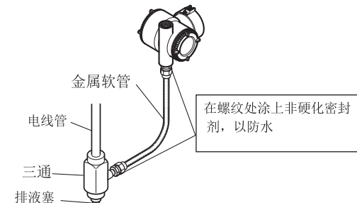
图 5.15 金属软管典型接线
